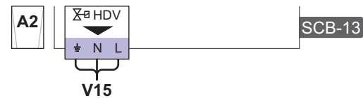
Fig.34 Raccordements électriques - Chaudière suiveuse - SCB-13
